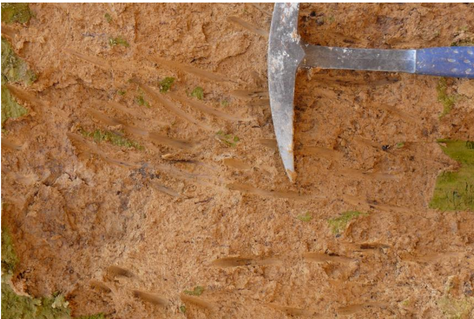
Sehr stark tonig ausgebildeter Lösslehm („fetter Lösslehm“)
