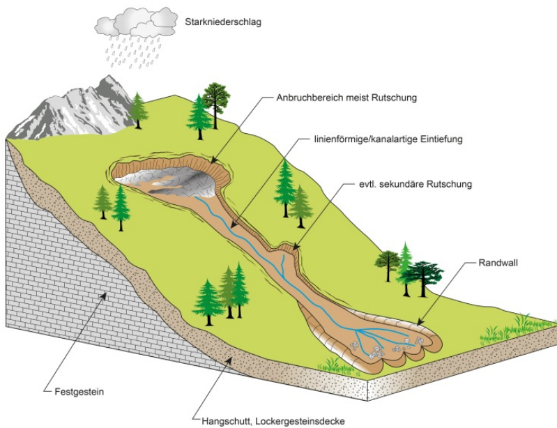
Schematisches Blockbild einer Hangmure mit typischen Charakteristika im Gelände
