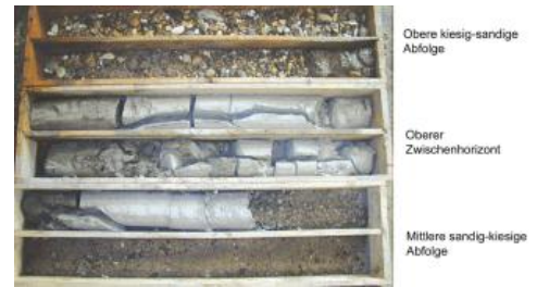
Oberer Zwischenhorizont (Ludwigshafen-Formation) in der Bohrung BK 1A Hauf, darüber die Obere kiesig-sandige Abfolge (Mannheim-Formation), darunter die Mittlere sandig-kiesige Abfolge (Viernheim-Formation)
