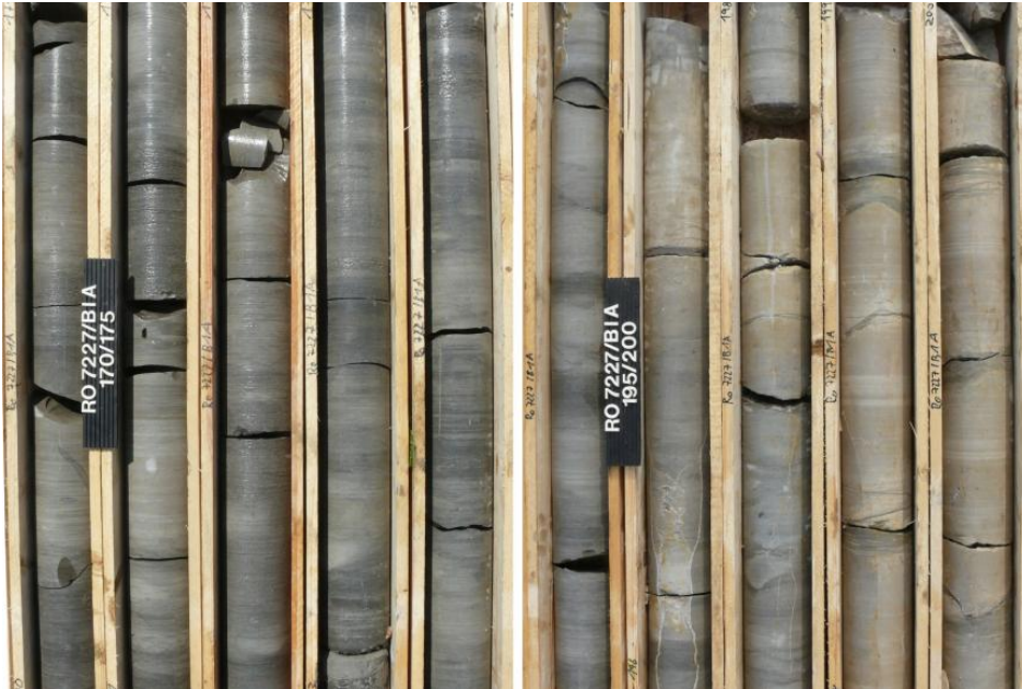
Bohrsequenz der Lacunosamergel- und Wohlgeschichtete-Kalke-Formation
