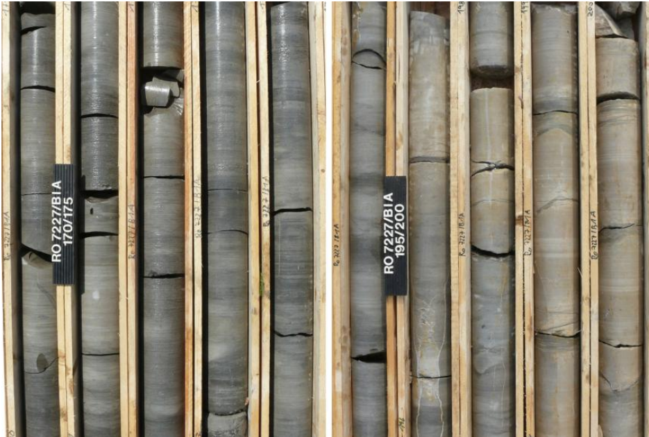
Bohrsequenz der Lacunosamergel- und Wohlgeschichtete-Kalke-Formation
