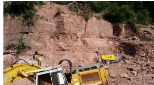
Durch Bohren und Keilen werden Rohblöcke gelöst.
