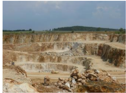
Der Kalksteinabbau im Steinbruch Giengen an der Brenz wird über fünf Sohlen betrieben.
