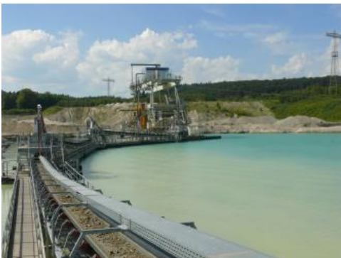
Nassabbau mittels Schwimmbagger
