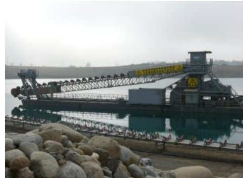
Eimerkettenbagger in einem Baggersee
