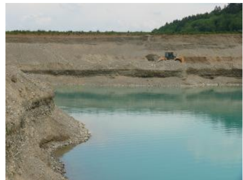
Rheingletscher-Niederterrassenschotter im Trocken- und Nassabbau
