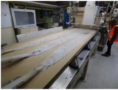
Produktion von Gipskartonplatten
