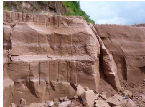
Steinbruch zur Gewinnung von Werksteinblöcken (Hartsandstein)
