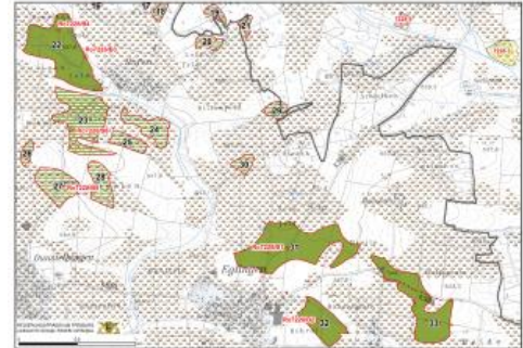
Ausschnitt aus der KMR 50 Blatt L 7326/L 7328 Heidenheim a. d. Brenz/Höchstädt a. d. D. mit Rohstoffvorkommen des Trasszementrohstoffs Suevit
