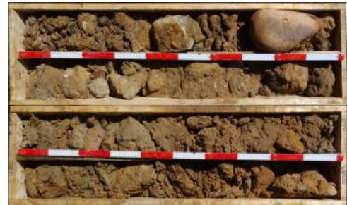
Stark verwitterter bis entfestigter Schotter der Wasser-Subformation in einer Bohrung aus Freiburg i. Br. – Die Gerölle bestehen überwiegend aus Gneis und Granit lokaler Herkunft (Schwarzwald).
