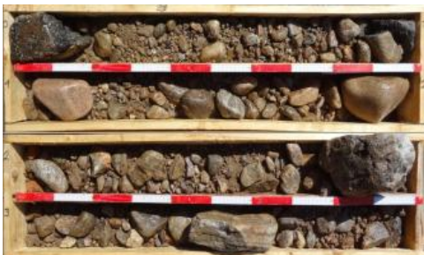
Unverwitterter Schotter der Zarten-Subformation in einer Bohrung aus Freiburg i. Br. – Die Gerölle bestehen überwiegend aus Gneis und Granit lokaler Herkunft (Schwarzwald).
