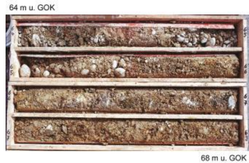
Breisgau-Formation in der Bohrung Hartheim B 1 (LGRB-Archiv-Nr. BO 8011/492)
