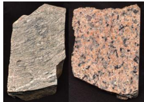
Handstücke eines Gneisanatexits (links) und eines grobkörnigen Bärhalde-Granits aus dem Südschwarzwald
