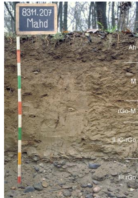
Kalkhaltiger Auengley-Brauner Auenboden aus Auensediment über Rheinschotter (humose Pararendzina mit reliktschen Gleymerkmalen)
