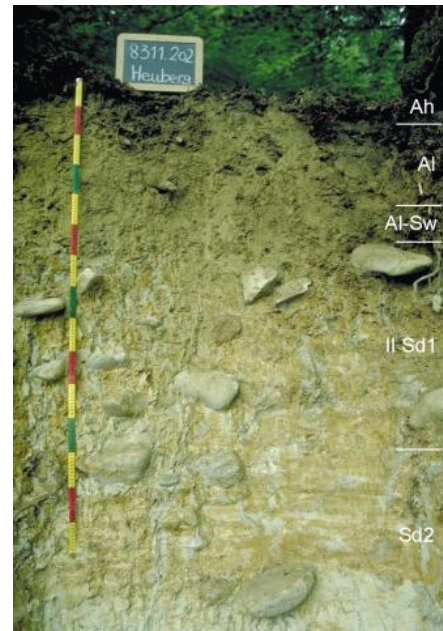
Tief entwickelte Pseudogley-Parabraunerde aus Decklage über Heuberg-Schotter
