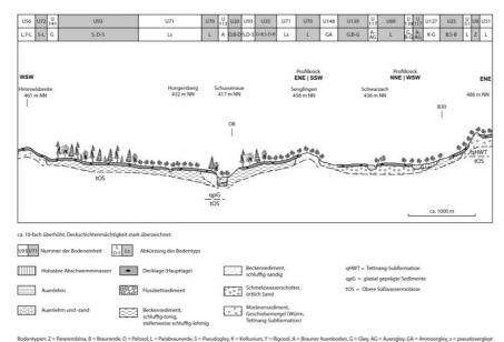
Das Schussenbecken zwischen Ettenkirch und Ravensburg, schematischer Profilschnitt
