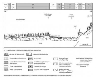
Die Argenterrassen, schematischer Profilschnitt
