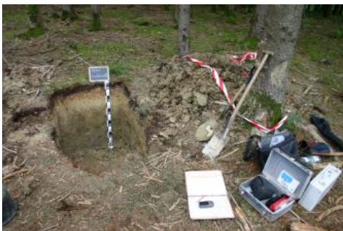
Anlage eines Musterprofils
