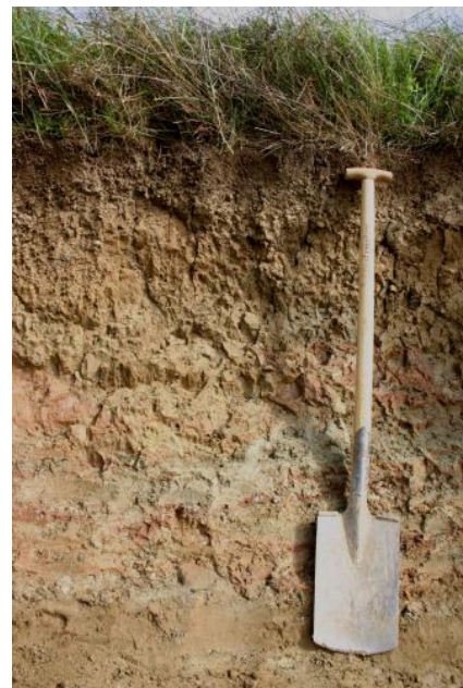
Mäßig tief entwickelter brauner Pelosol aus geringmächtiger lösslehmhaltiger Fließerde über tonreicher Fließerde über Mergelstein der Unteren Süßwassermolasse
