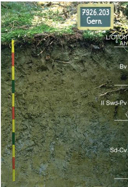
Mäßig tiefe pseudovergleyte Pelosol-Braunerde aus lösslehmhaltiger Decklage über tonigem Zersatz der Oberen Süßwassermolasse
