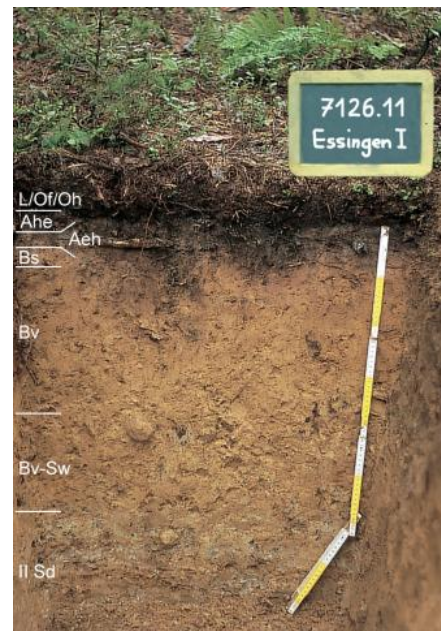
Tief entwickelte schwach pseudovergleyte Podsol-Braunerde aus sandigen Fließerden über Sandsteinzersatz (Eisensandstein-Formation, Begleitboden in m81, Musterprofil 7126.11)
