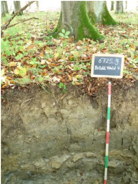
Pseudovergleyter Braunerde-Pelosol aus einer geringmächtigen lösslehmhaltigen Fließerde über einer tonigen Basislage über Gesteinszersatz des Lettenkeupers
