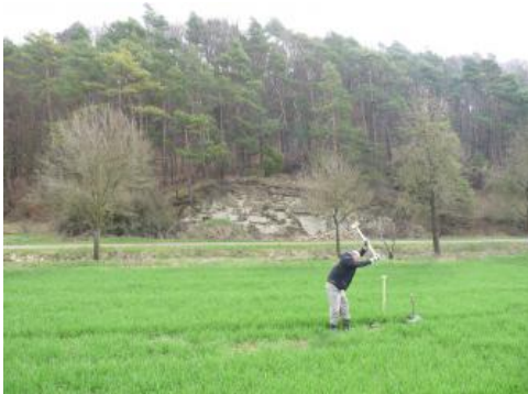
Bodensondierung in einem Trockental bei Werbach-Wenkheim
