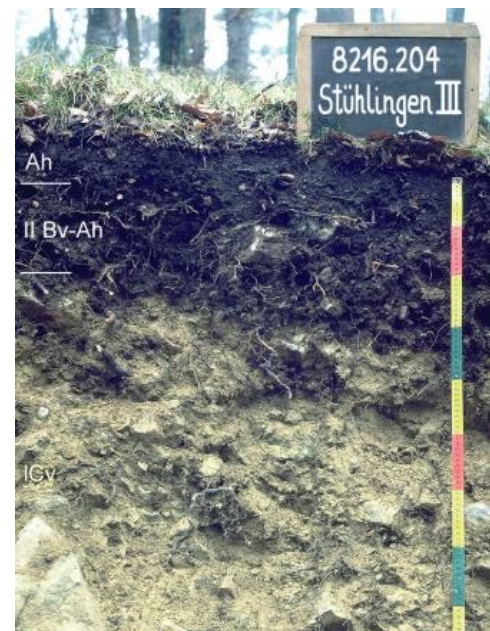
Braunerde-Rendzina (h4) aus geringmächtiger lösslehmhaltiger Fließerde über Hangschutt auf Trigonodusdolomit (Rottweil-Formation, Oberer Muschelkalk)
