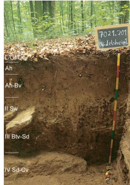
Lessivierter Braunerde-Pseudogley aus lösslehmiger sandiger Fließerde über sandig-toniger Fließerde auf grusig-toniger Unterkeuper-Fließerde (f21)
