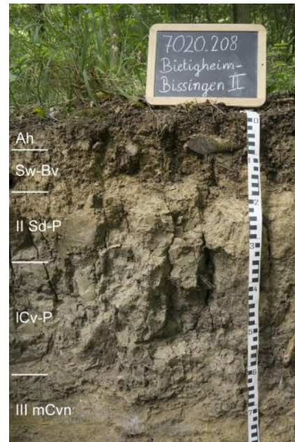
Mäßig tief entwickelter Pseudogley-Braunerde-Pelosol aus geringmächtiger lösslehmhaltiger Fließerde über tonreicher Fließerde aus Lettenkeupermaterial auf Mergelstein (f16)
