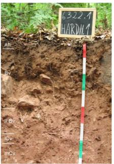
Mittel tief entwickelte Braunerde aus Sandstein führender, lösslehmhaltiger Fließerde (Decklage) über Zersatz des Rötquarzits (D81)
