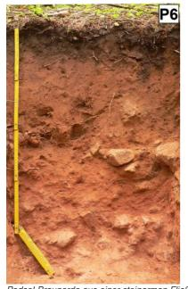
Podsol-Braunerde aus einer steinarmen Fließerde über Schutt und Zersatz des Unteren Buntsandsteins (D17)
