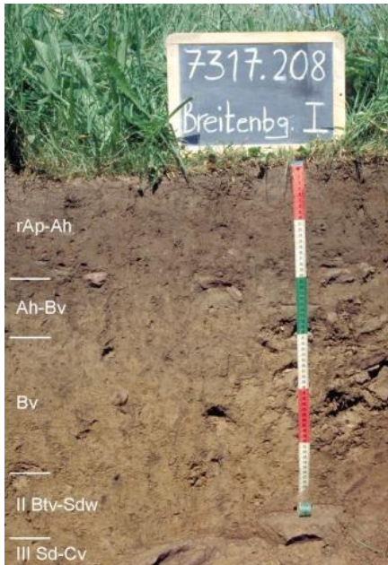
Mäßig tief entwickelte pseudovergleyte Braunerde aus lösslehmhaltigen Fließerden über Sandsteinzersatz (b12)
